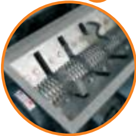
Detail: Grinding chamber Particolare: camera di macinazione
