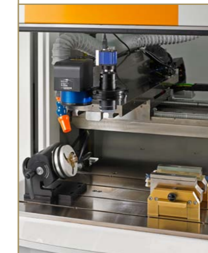
Motorized axis tilting for internal and external marking on circumferences with universal clamp. Indexing accuracy: 4800 step/rev. Mandrin inclinable motorisé pour gravure intérieure et extérieure sur circonférences avec mors universel. Précision d'indexage: 4800 pas/min.
