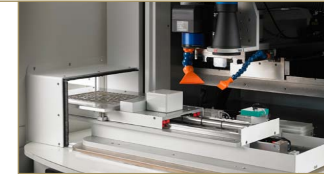
Withdrawal of the new pallet from the automatic store and transfer on the marking position. Retrait du nouveau plateau du magasin automatique et transfert sur la position de marquage.
