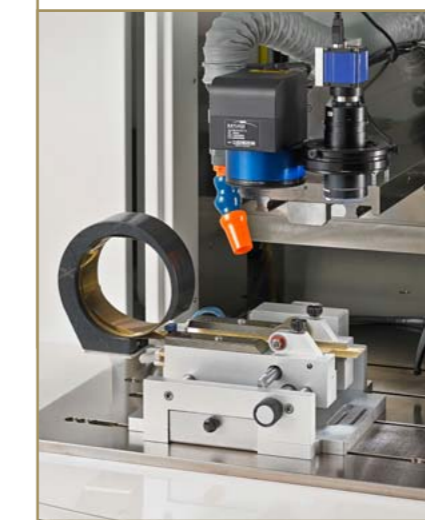
Automatic guide-plate dragger for continuous feeding of the marking and cutting cycle. Adjustable width between 10-100 mm. Dérouleur guide de bande automatisé pour le marquage et la découpe fine en continue. Largeur réglable entre 10-100 mm.
